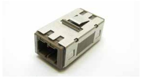
Kuva 4.7. MU-liitin ja MU-adaptteri.
