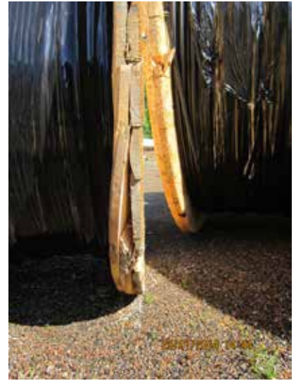
Kuva 7.2. Esimerkki pudotuksessa vaurioituneesta kelasta (Kuvat: Voimatel Oy).
