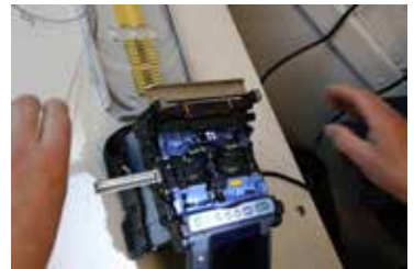
Jatkettu kuitu siirretään kuitujatkoskoneen uuniin.
