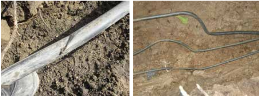
Kuva 10.3. Esimerkkejä asennusten yhteydessä kaapeleihin tulleista vioista (Kuvat: Elisa Oyj).
