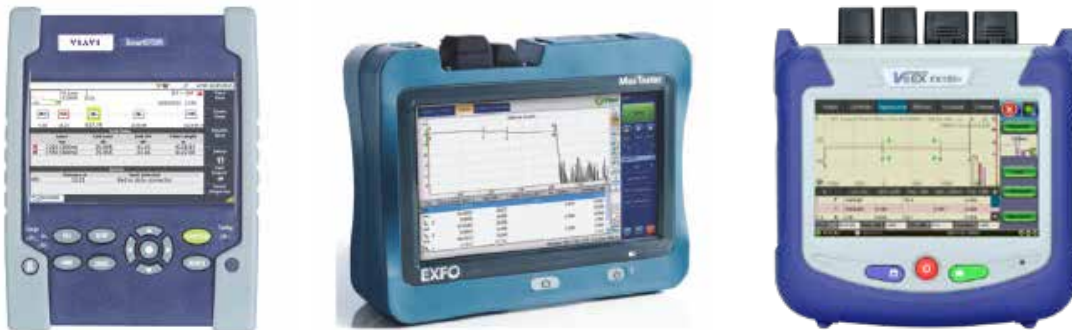
Kuva 9.8. Esimerkkejä valokaapelitutkista (Viavi, EXFO, VeEX).
