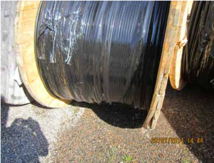
Kuva 7.2. Esimerkki pudotuksessa vaurioituneesta kelasta (Kuvat: Voimatel Oy).
